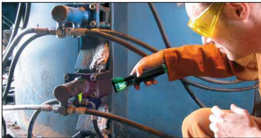
Detección de fugas en válvulas y conexiones usando la linterna de luz azul, de diodos - LED - OPTIMAX™ 3000
