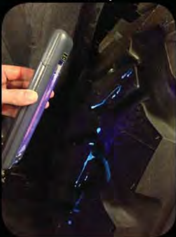
Grieta en un rin identificada Por Sentry
