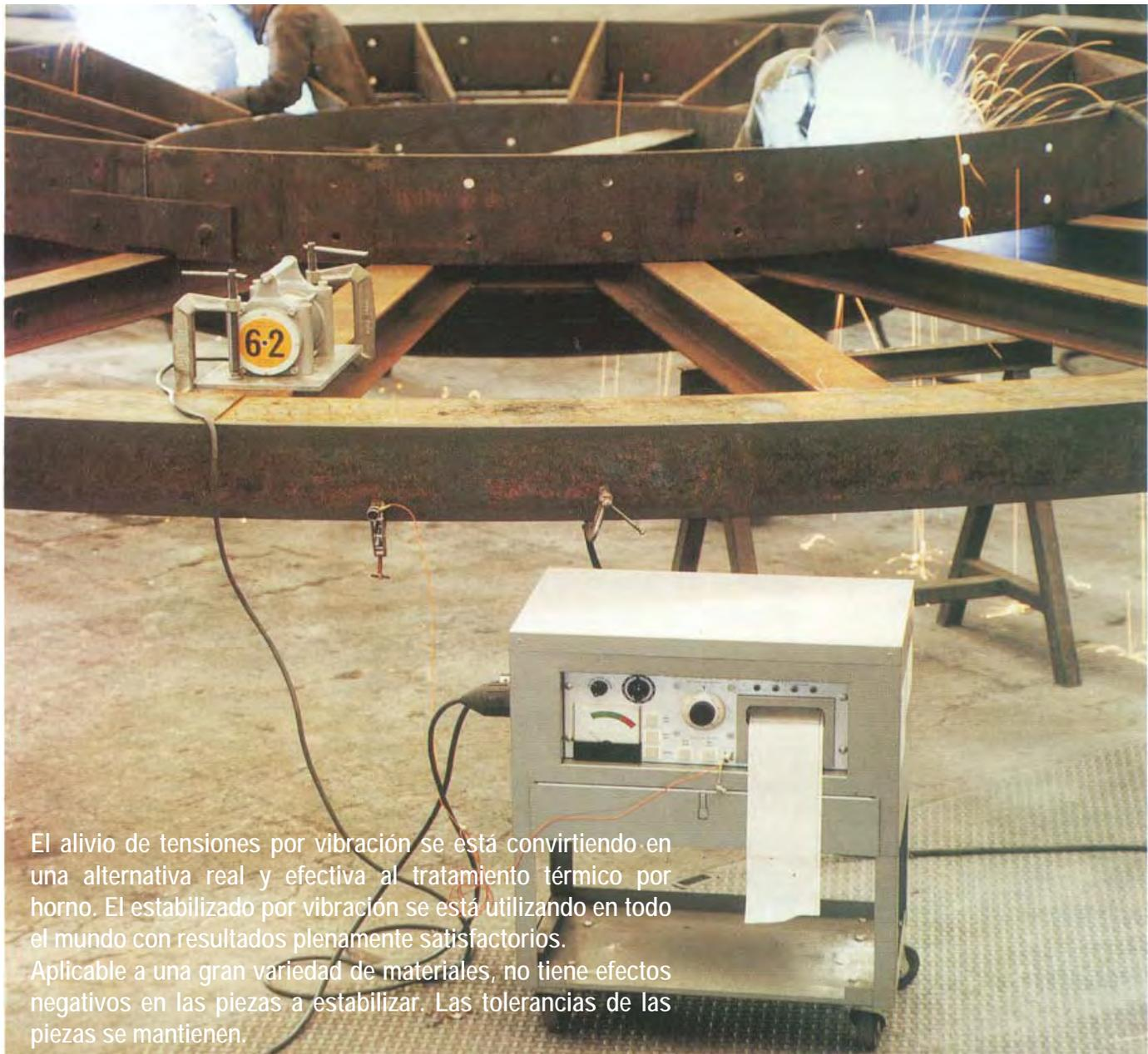
El alivio de tensiones por vibración se está convirtiendo en una alternativa real y efectiva al tratamiento térmico por horno. El estabilizado por vibración se está utilizando en todo el mundo con resultados plenamente satisfactorios.
