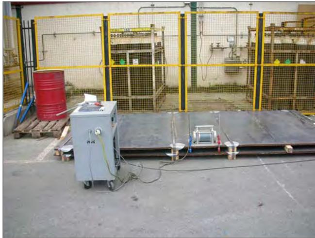
Para construcciones soldadas, el alivio de esfuerzos se puede realizar durante la soldadura, lo que es de gran ayuda en la prevención de la acumulación de esfuerzos que podrían provocar la quebradura o deformación de algunas secciones. La soldadura produce grandes cambios de temperatura en poco tiempo; si aplicamos vibración mientras soldamos o inmediatamente después del soldeo, atenúamos enormemente las tensiones generadas.
